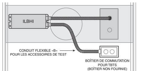
A. Découpez un boîtier de commutation simple dans la tuile du plafond adjacente au luminaire et à la portée du conduit flexible de l'ILBHI CP HE SD HV marqué d'un « B ». Après avoir installé le boîtier de commutation, branchez le conduit flexible au boîtier et faites passer tous les fils dans le boîtier.
