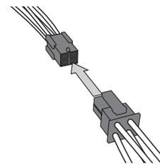
C. Connectez et engagez complètement le connecteur du TBTS dans la douille du TBTS. Assurez-vous que le connecteur du TBTS est bien en place dans sa douille, puis marquez son emplacement sur la plaque de la boîte de distribution à l'aide de l'étiquette TBTS et apposez l'autocollant de l'indicateur de statut SD.
