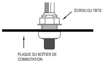
B. Fixez la plaque du boîtier de commutation dans le boîtier de commutation. Insérez le TBTS dans le trou de la plaque du boîtier de commutation de manière à ce qu'il fasse face à l'extérieur du boîtier de commutation. Fixez le TBTS contre la plaque en vissant sur l'écrou du TBTS.
